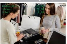
Kassendaten aus einer verbundenen Kasse werden auf dem Livebild einer Kamera eingeblendet. So sehen Sie im Bild was passiert und können direkt anhand der Kassendaten prüfen, ob beim Kassieren fehlerhafte Eingaben gemacht worden sind.
